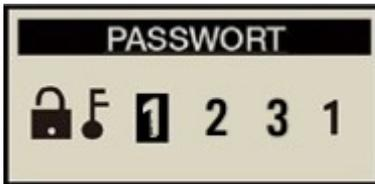
5) Die Pumpe wird ein weiteres PASSWORT verlangen, geben Sie **1231** in der Reihenfolge **1→1→2→3** ein und drücken **OK**.
