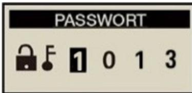
2) Die Pumpe wird ein **PASSWORT** verlangen, geben Sie **1013** in der Reihenfolge **3→1→0→1** ein und drücken Sie **OK**.
